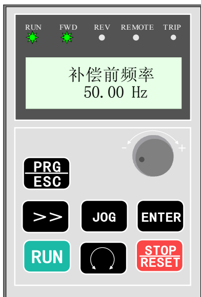
图3 运行状态，RUN灯亮，运行到设定频率稳速时FWD恒亮
