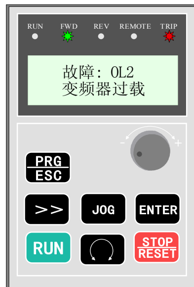
图6 故障时，显示故障代码及故障名，TRIP故障指示灯闪烁
