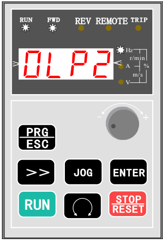
图5 告警时，闪烁显示 告警字符
