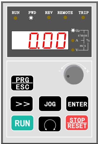
图2 停机状态，RUN灯熄灭 FWD慢闪指示设定方向
