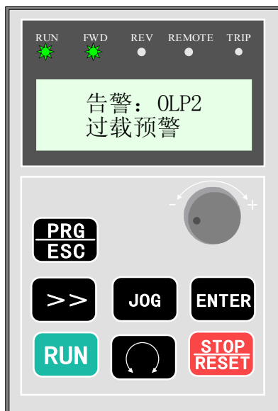
图5 告警时，闪烁显示告警字符
