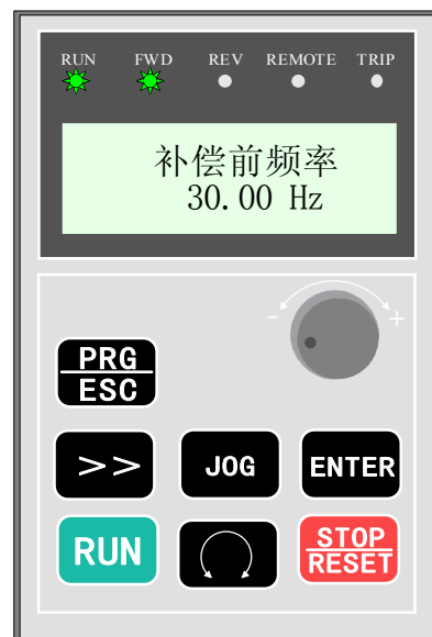
图3 运行状态，RUN灯亮，加速中FWD指示灯快闪
