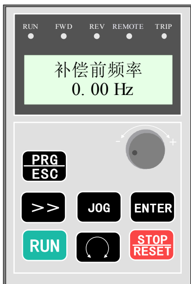
图1 上电初始化显示，补偿前输出频率为0.00Hz
