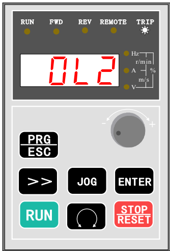
图6 故障时，显示故障代码 TRIP故障指示灯闪烁
